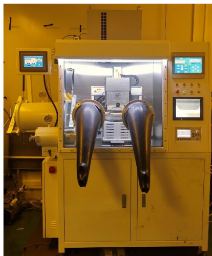
图3 电毛细力驱动互联填充原理与柔性电子系统互联封装平台
