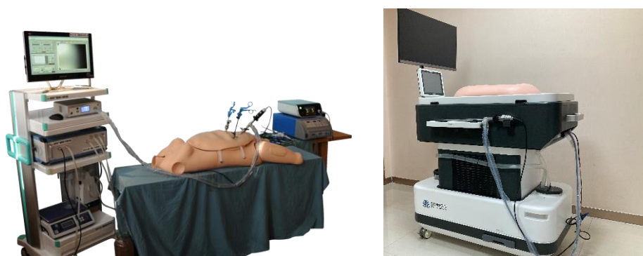
图1 真肝模拟人腹腔镜训练平台（左图原理样机，右图为成果转化产品）
